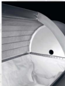
pneumatický lis – uzavřený + detail vnitřní části bubnu s odtokovými kanály
