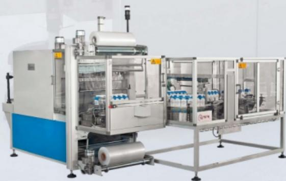
balící stroje do smrštětelné fólie – poloautomatická nebo automatická provedení
